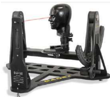
그림 4 : 헬멧을 헤드폼에 장착하고 다양한 각도에서 시험된 NIJ 정적 FOV 장비
