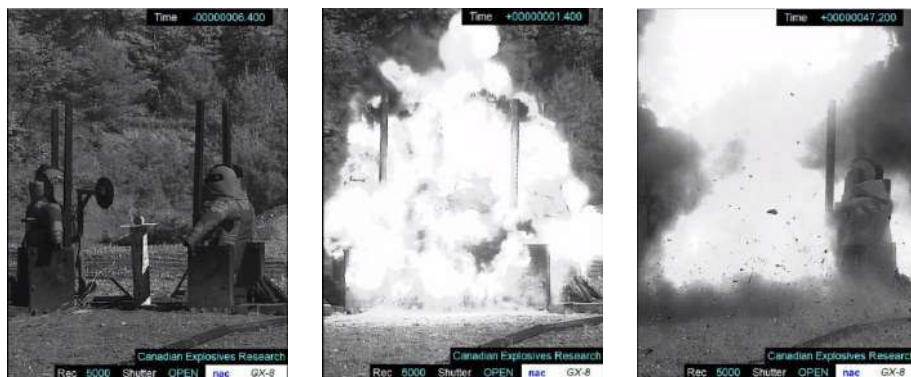
그림 2 : NIJ 0117.01 폭발 과압 시험에 대한 고속 비디오 이미지. 무릎꿇고 마주하여 2 ft (0.6m) 거리에서 1.25 lbs (0.567kg)의 C-4 폭발. 더 많은 데이터를 위해 2개의 마네킹을 이용.
