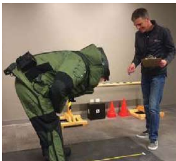
그림 5 : NIJ Dynamic FOV 테스트 - 머리 및 신체 움직임
