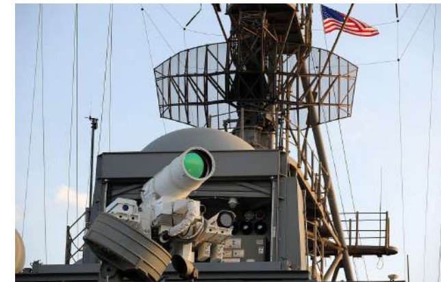
그림 7. LaWS 레이저 타격무기 시스템
