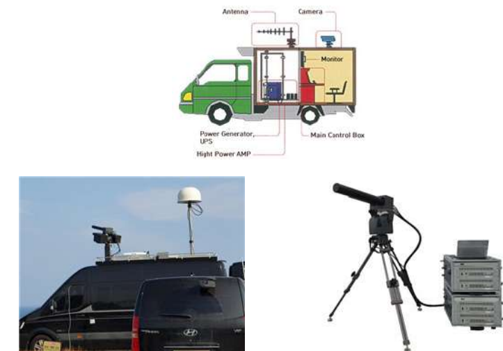
〈그림 6, 차량 탑재용 고출력 전파 차단 장비〉
