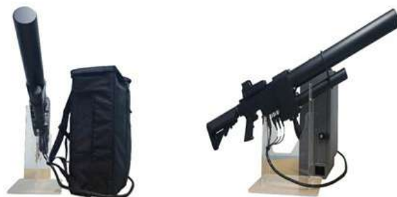
〈그림 5, 휴대용 Anti-Drone Gun〉
