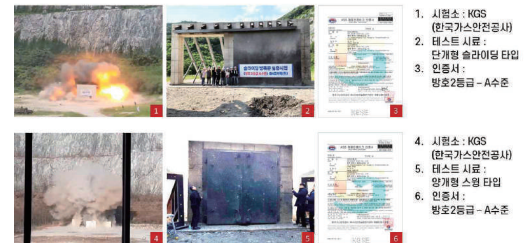
〈그림 2〉 한국가스안전공사 방폭문 제품인증 시험
